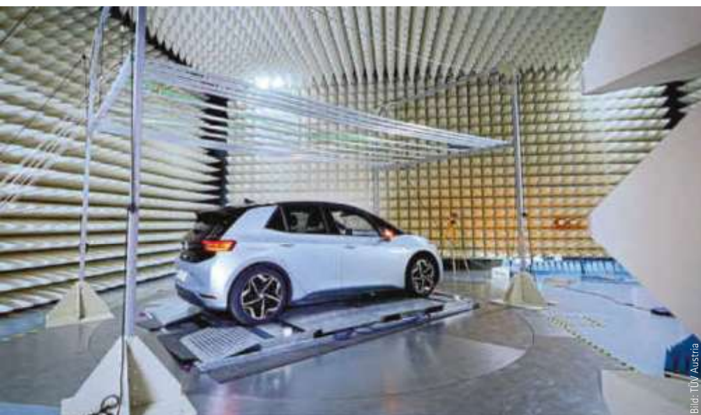
TÜV Austria betreibt seit 2021 in seinem Technology & Innovation Center in Wien ein modernes Labor zum Prüfen von Komponenten der AC- und DC-Ladeinfrastruktur für Elektromobilitätsanwendungen
